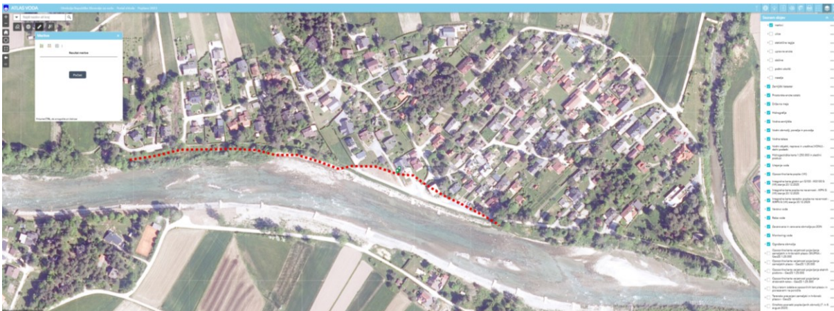
Slika 4: Prikaz erozijske linije ob poplavi glede na današnje stanje.
