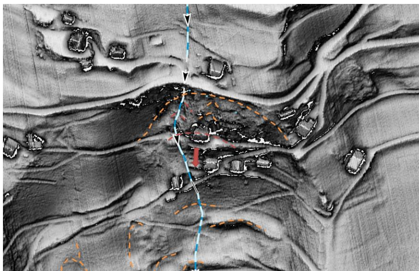
Slika 3: Pogled na ponovno aktiviran plaz v okolici in na objektu Lipa pri Frankolovem 12 – označeno z rdečo puščico. Z modro črto so prikazani vidni tokovi vode, z modrimi pikicami pa izviri - dotoki precejne vode iz pobočja. Precejne vode v triasnih apnencih ponikajo preko razpok in se na kontaktu z glinavci in laporjem pojavljajo (na površju) kot posamezni izviri, veliko precejne vode se pretaka v površinskih plasteh preperelega laporja.
