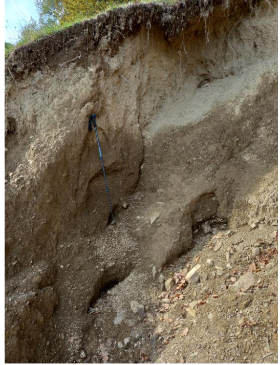
Fotografija 10: Večja debelina grušča na spodnjem delu usada nad objektom Savina 45a. Debelina zaglinjenega grušča do 2,5 m. Znaki dotokov vode.
