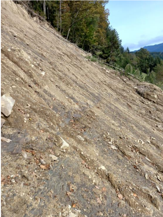
Fotografija 9: Zgornji del večjega usada nad objektom Savina 45a in Savina 45. Izdanja trdna podlaga – glinavec in tufit.
