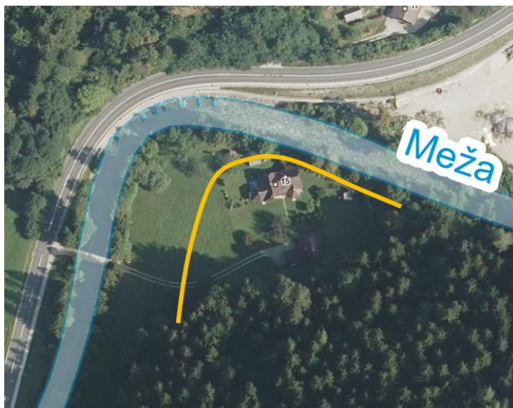
Slika 8: Primer ureditve visokovodnega zidu/nasipa na območju objekta
