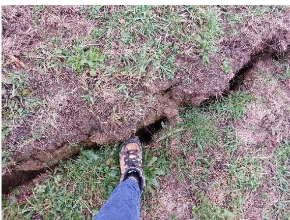
Fotografija 3: Razpoke dolžine cca 40-50 m v zaledju objekta Veliki Vrh 41 (21.11.2023)
