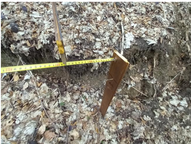
Slika 8 – izmerjeni premiki na zgornjem bočnem odlomnem robu – premiki v zadnjih dveh mesecih. Zabeležen premik vzdolž pobočja – 22 cm, višinsko 13 cm posedek, premik vzhodno – 18 cm.
