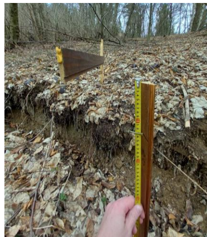
Slika 8 – izmerjeni premiki na zgornjem bočnem odlomnem robu – premiki v zadnjih dveh mesecih. Zabeležen premik vzdolž pobočja – 22 cm, višinsko 13 cm posedek, premik vzhodno – 18 cm.
