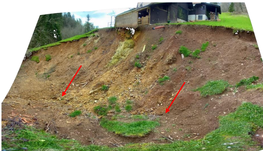
Slika 5 – prikaz plazu pod objektom Laniše 15 in lokacije dveh močnejših izvirov. Veliki dotoki vode.
