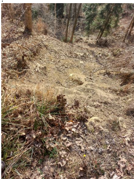
Fotografija 5: Odlomni rob na osrednjem del, kjer so v sestavi vidni prodniki (preperel konglomerat) in grušči peščenjaka (6.2.2024).
