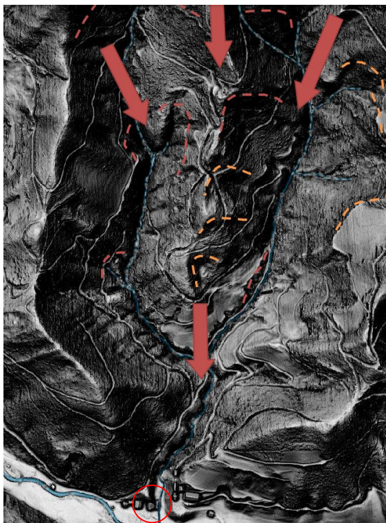
Slika 2: Pogled na aktiviran hudourniški plaz. Rdeča črta prikazuje odlomne robove, ki so povzročili nastanek hudourniškega drobirskega toka. Oranžna črta prikazuje starejše odlomne robove. Smer plazenja označena z rdečimi puščicami. Lokacija objekta Spodnji Razbor 59 je označena z rdečim krogom.
