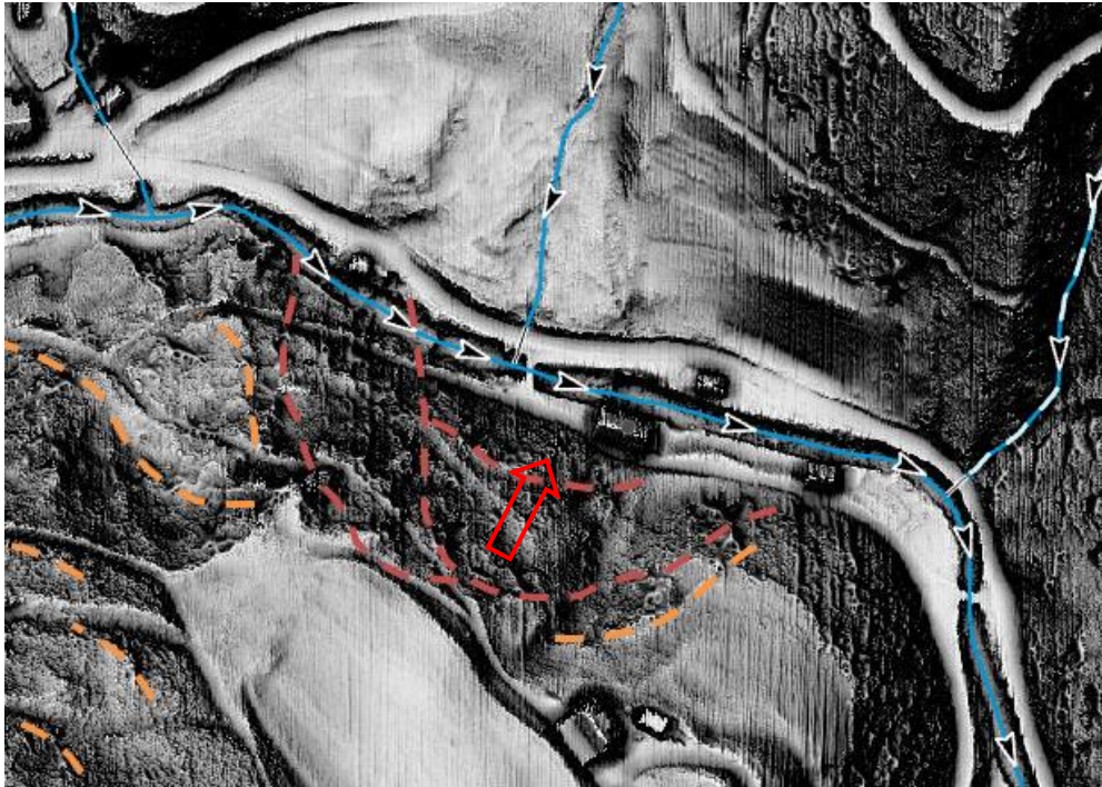
Slika 2: Pogled na ponovno aktiviran plaz nad objektom Spodnji Razbor 4 – označeno z rdečo puščico. Rdeča barva nakazuje nove odlomne robove, z oranžno barvo označujemo starejše kamnite pobočne premike.
