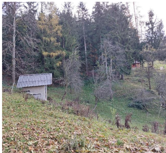
Fotografija 2: Pogled na zaledje stanovanjskega objekta, kjer morfologija terena in nagnjenost dreves nakazuje na fosilni plaz (15.11.2023)
