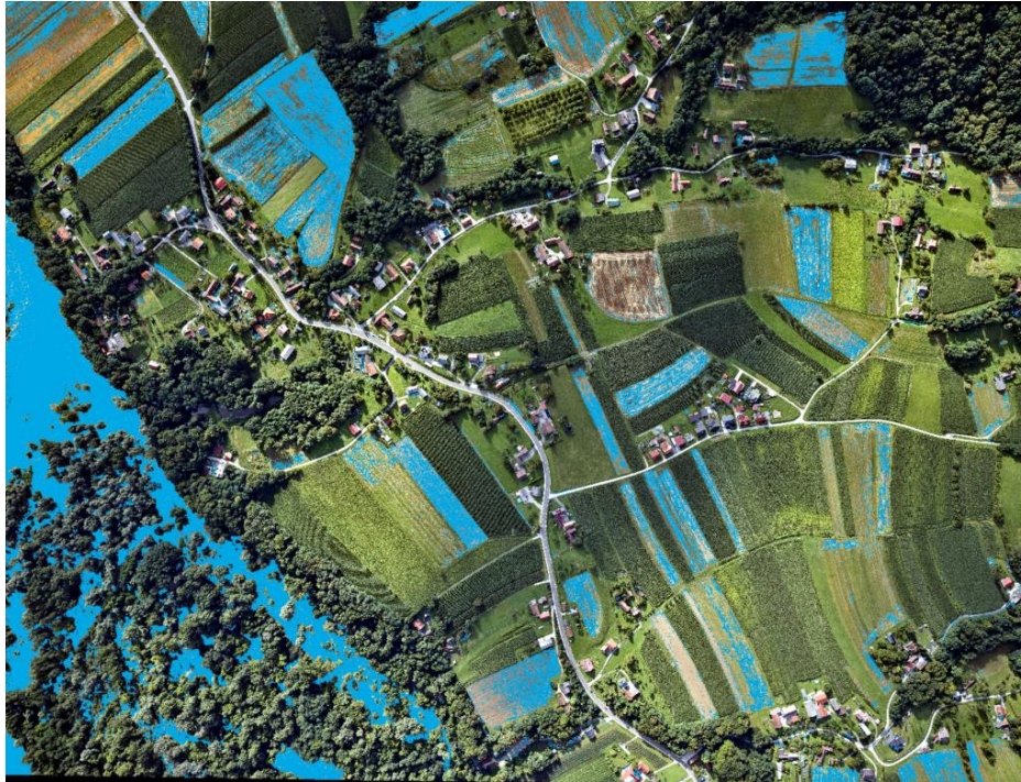
Slika 3: Poplavljeni območja, pridobljenega iz produkta zračnega laserskega in aerofotogrametričnega snemanja
