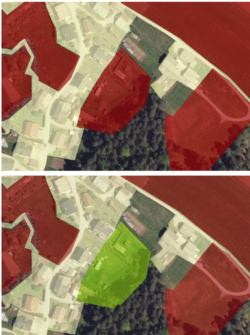
Slika 16: Primeri zaokroževanja glede na velikost poligona. Na prvi sliki je rezultat modela, na drugi pa rezultat po zaokroževanju. Poligona sta velika približno 0,15 ha in smo tako na osnovi podatkov smiselno določili OKZ.
