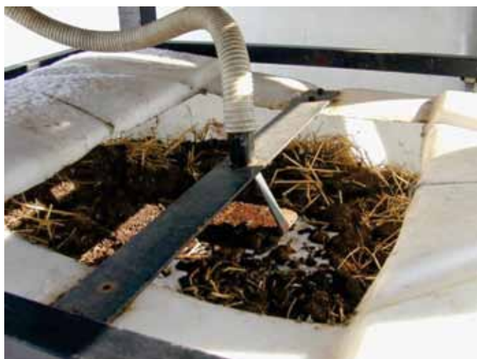
Slika 19 in 20: Porazdelitev kontaminirane tekočine po površini s pomicjo kovinske plošče (levo, vir Craw) ali z zaokroženo preluknjano cevjo (desno, vir pcfriut).
