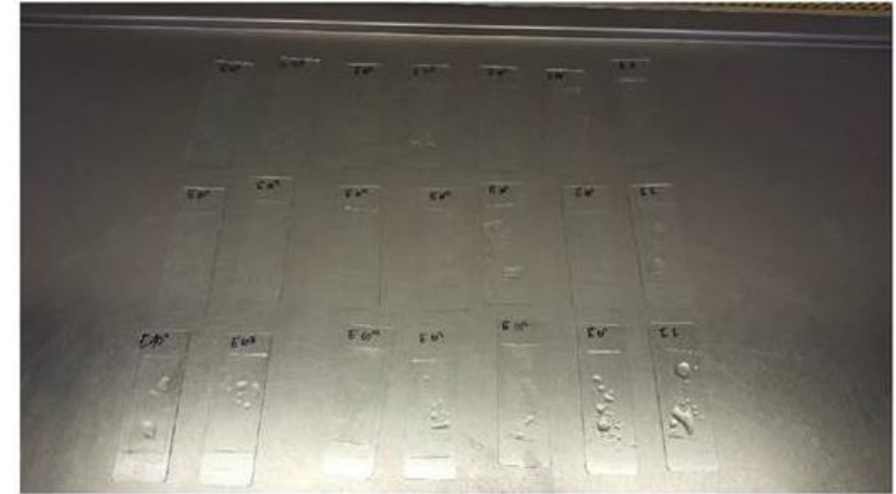
Figura 10. Fragmentos de cinta empleada en capturadores Burkard inoculada con dilución de conidias.
