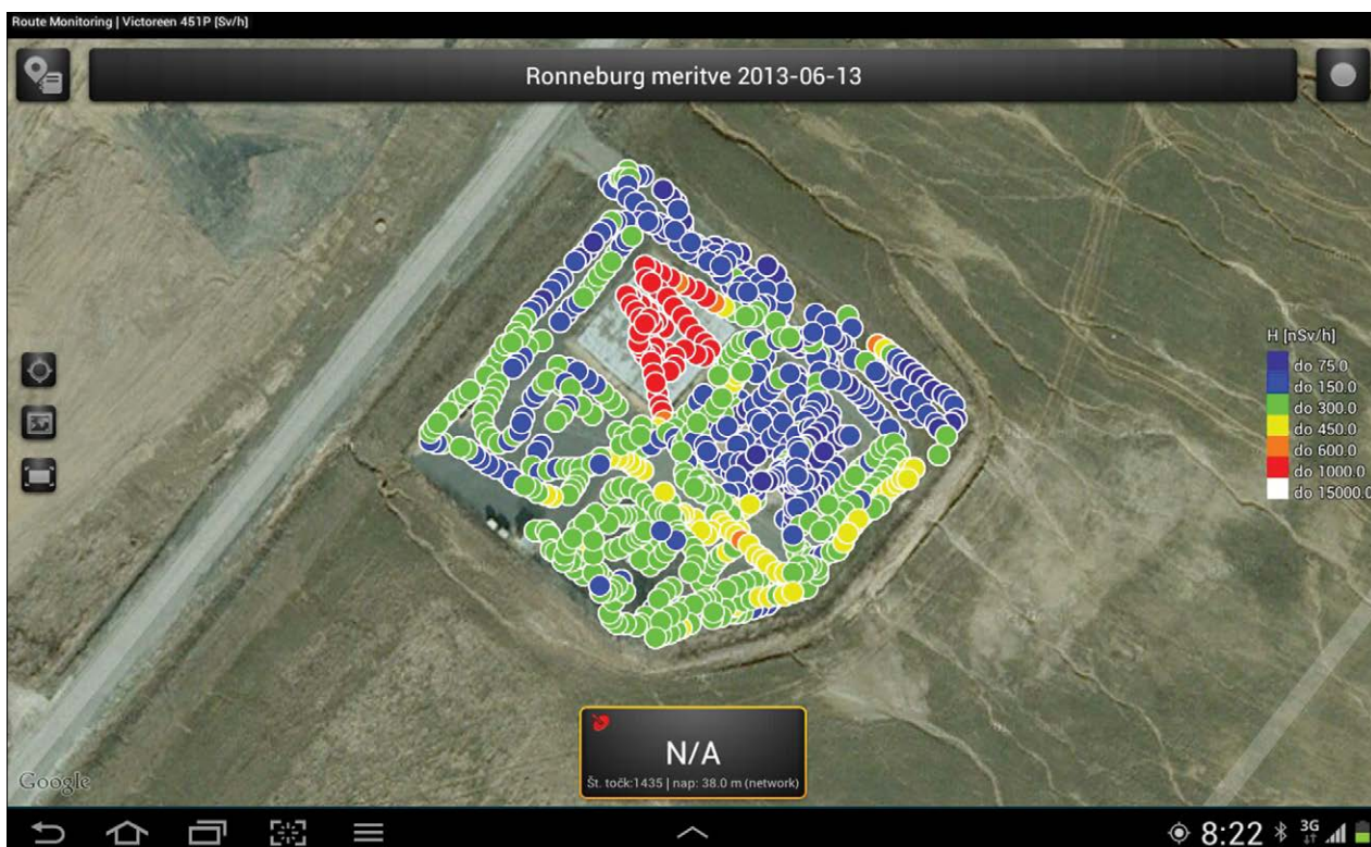
Slika 3: Sistem za kartiranje hitrosti doze zunanjega ionizirajočega sevanja, v katerega bomo integrirali sistem za prostorsko lociranje in analizo sevalnih polj gama
