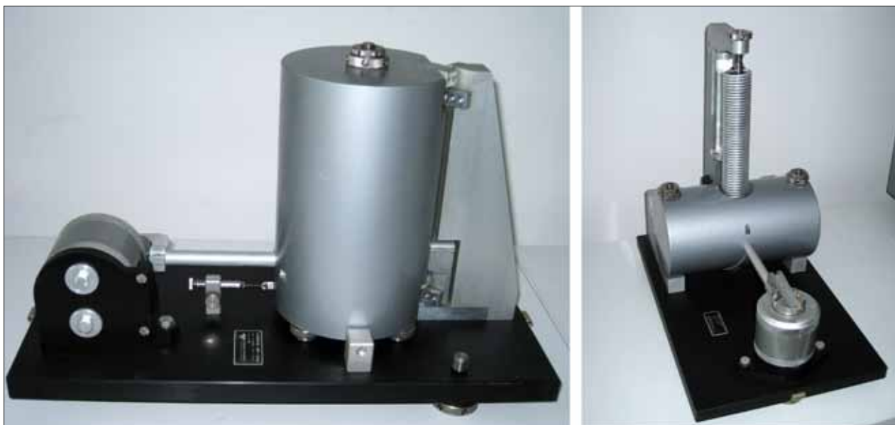
Slika 1: Kratkoperiodna seizmometra Lehner & Griffith podjetja Teledyne, namenjena merjenju lokalnih potresov; levo: vodoravna komponenta, desno: navpična komponenta (foto: A. Gosar)
