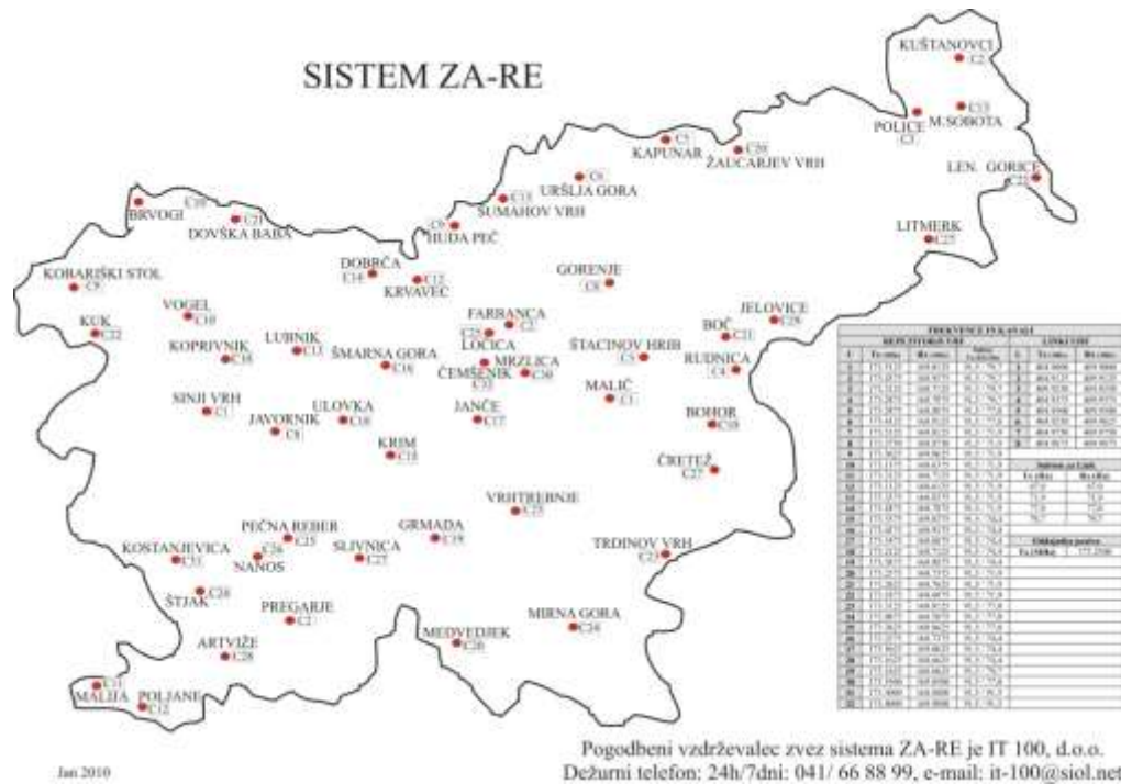
Slika 6: Repetitorske postaje s kanali sistema ZA-RE
