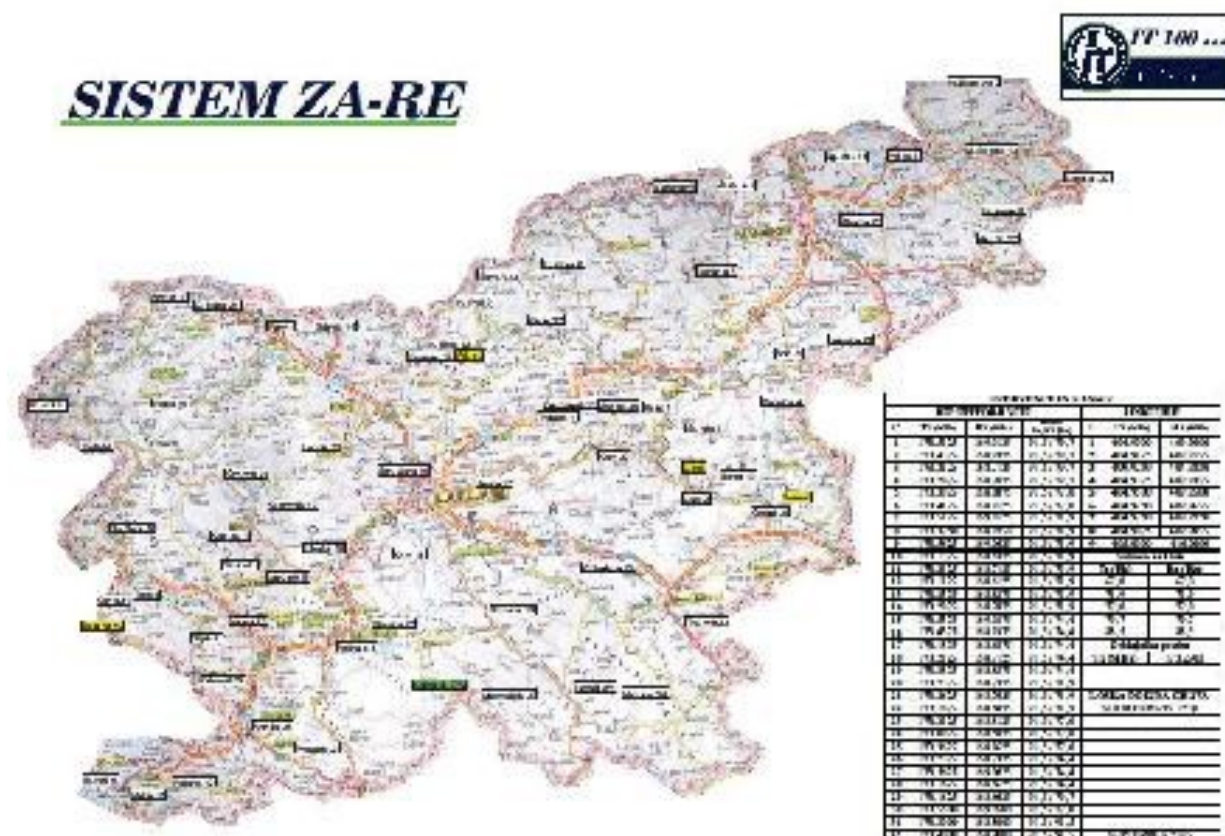
Slika 3: Repetitorske postaje s kanali sistema ZA-RE
