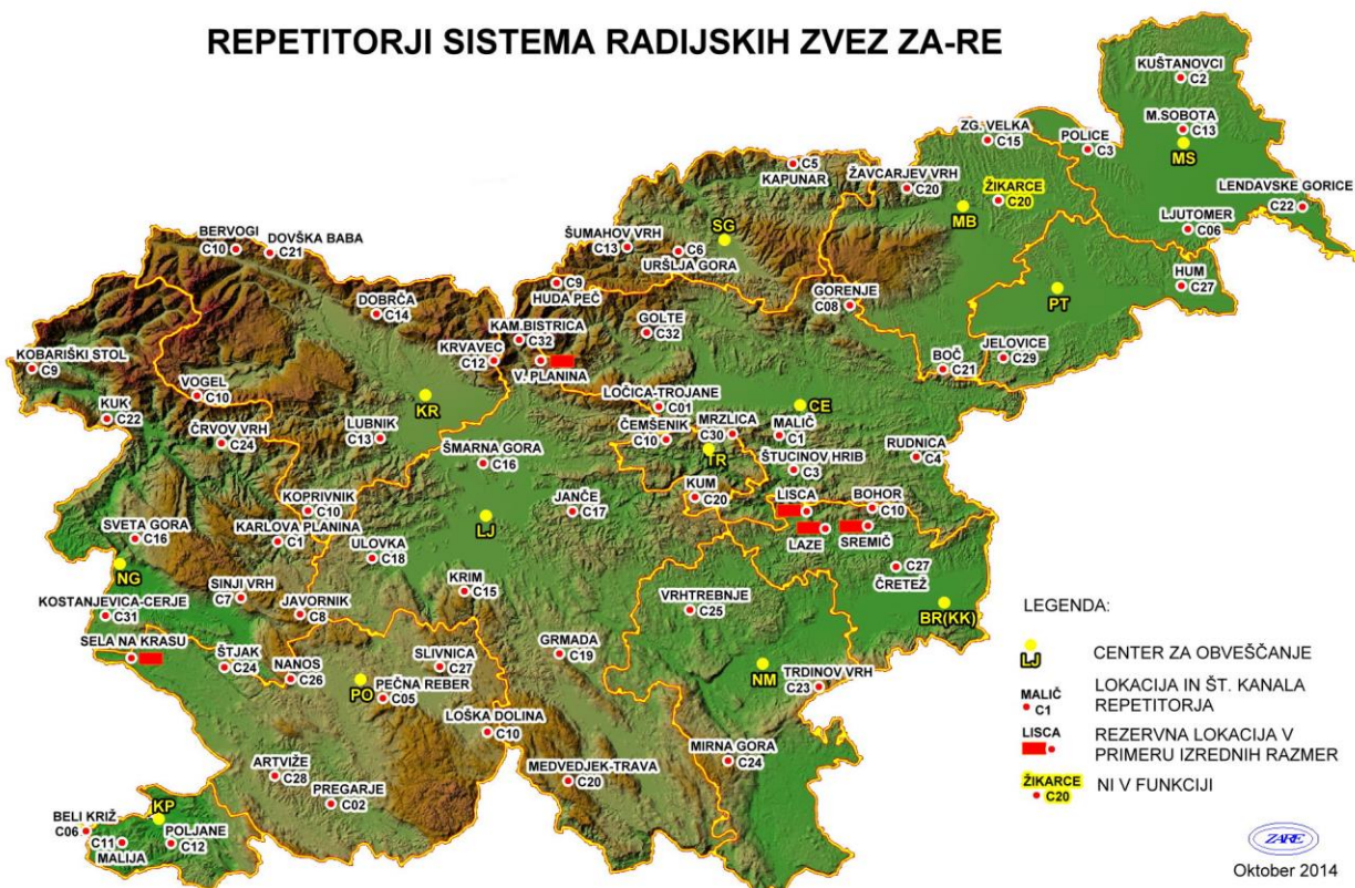
Slika 5: Repetitorske postaje s kanali sistema ZA-RE
