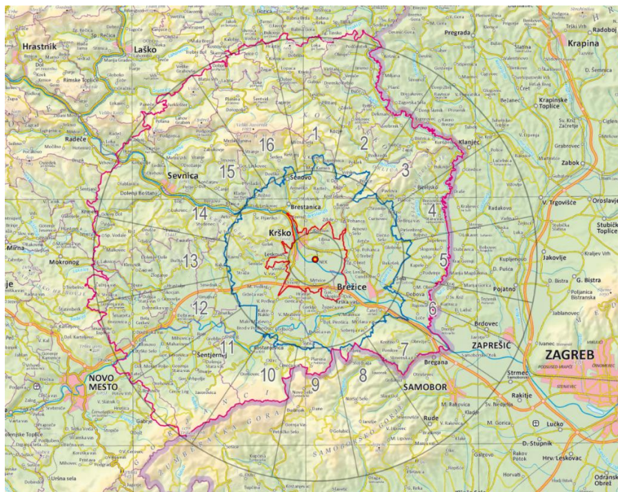
Slika 1: Območja načrtovanja zaščitnih ukrepov ob jedrski nesreči v NEK. OPU (3 km), OTU (10 km) in ROU (25 km).
