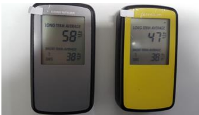
Slika 27: primer meritve za potrditev uspešnosti sanacije.
