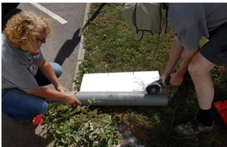
Slika 19: cev za zajem Rn222 med krojenjem.
