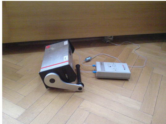
Slika 8. Merjenje koncentracije radona v kabinetu (jašek) in v učilnici 1-3 razred (razpoka)
