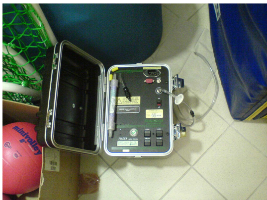
Slika 8. Merjenje koncentracije radona v kabinetu (jašek) in v učilnici 1-3 razred (razpoka)
