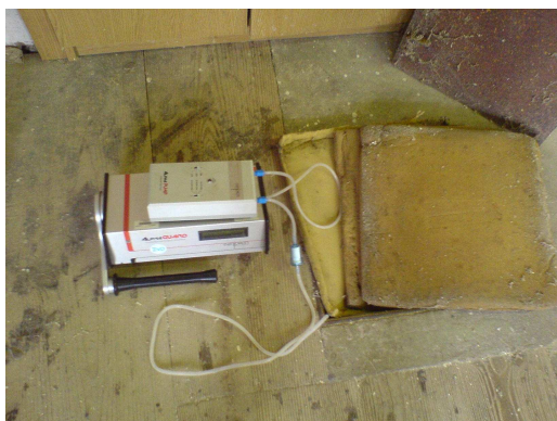
Slika 14. Koncentracije radona in potomcev v razpokah in jaških v mizarski delavnici
