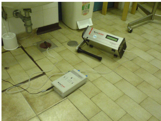
Slika 9. Merjenje koncentracije radona v sanitarijah (odtočni jašek) in avli (odtočni jašek)
