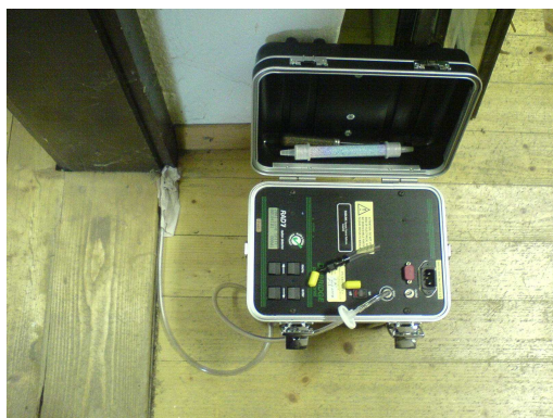
Slika 14. Koncentracije radona in potomcev v razpokah in jaških v mizarski delavnici
