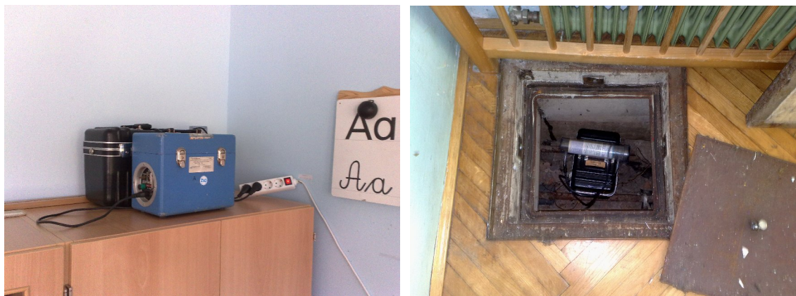
Slika 20. Merjenje koncentracije radona v prvi učilnici in v jašku v učilnici
