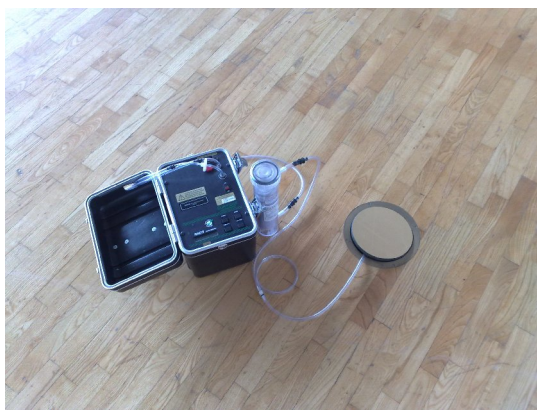
Slika 18. Merjenje koncentracije radona v glavnem jašku za monitorno vodo in v telovadnici
