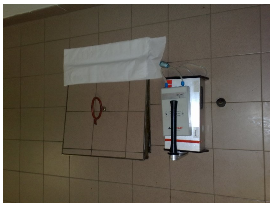
Slika 18. Merjenje koncentracije radona v glavnem jašku za monitorno vodo in v telovadnici
