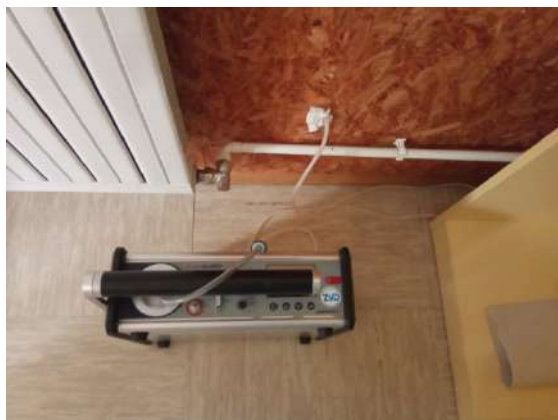
Slika 29. Luknja v steni v izolaciji v igralnici
