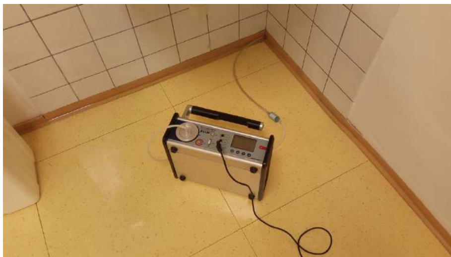
Slika 124. Meritve koncentracije radona v špranji
