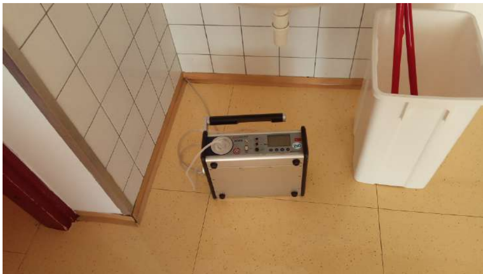
Slika 127. Meritve koncentracije radona v špranji
