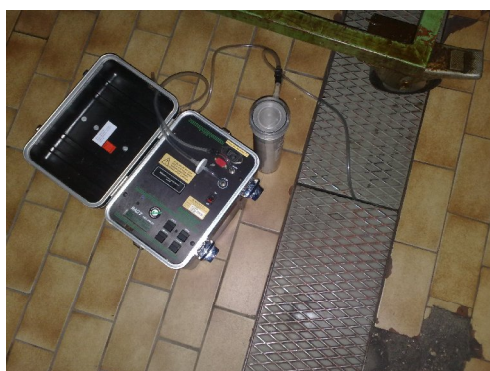
Slika 23. Radon v kanalu za el. napeljavo
