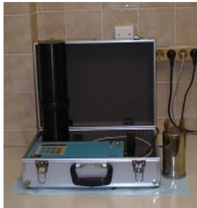
Slika 8: Alfa scintilacijski števec s scintilacijsko celico
