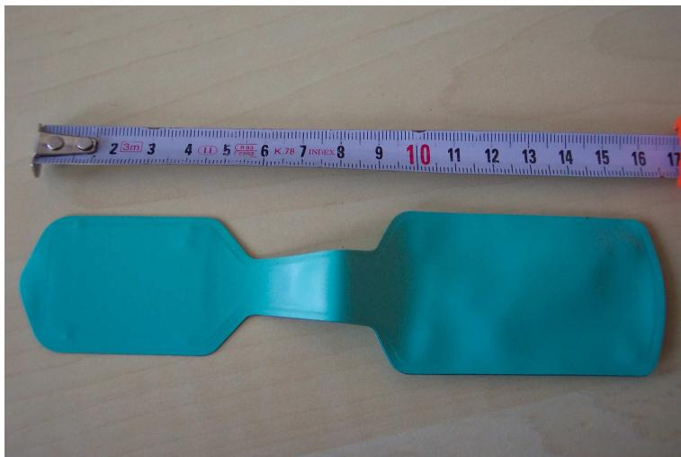
Slika 7: Fotografija samorazvijalnega dentalnega radiografskega filma, tudi ECO film. V levi vrečki je radiografski film, v desni pa kemikalije za razvijanje in fiksiranje filma. Po ekspoziciji kemikalije stisnemo skozi ozek del v vrečko s filmom in po petdesetih sekundah stiskanja je film razvit in ga vzamemo iz vrečke ter operemo in posušimo.
