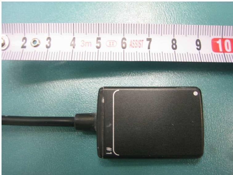
Slika 8: Fotografija dentalnega digitalnega senzorja za direktno digitalno radiografijo
