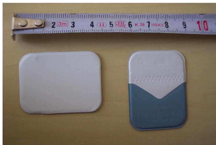
Slika 6: Fotografija klasičnega radiografskega dentalnega filma. Digitalni senzor pri dentalni računalniški radiografiji je enake velikosti in oblike.
