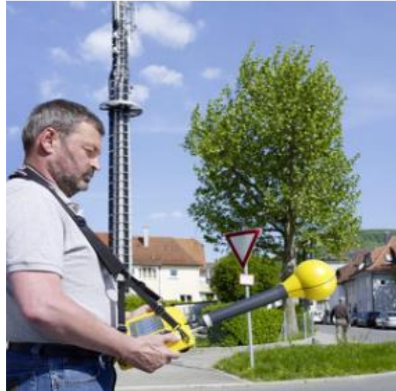
S 2: Uporabljen instrument za merjenje elektromagnetnega sevanja Narda SRM-3006 in primer izvajanja meritev EMS.
