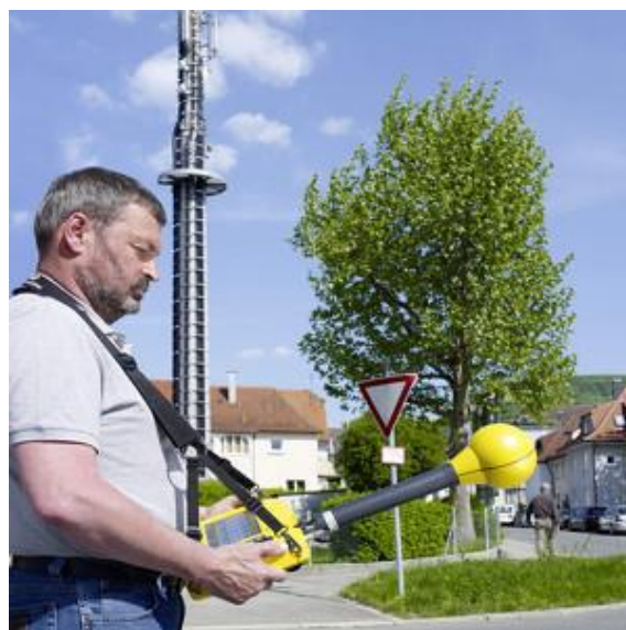
S 5: Uporabljen instrument za merjenje elektromagnetnega sevanja Narda SRM-3006 in primer izvajanja meritev EMS.
