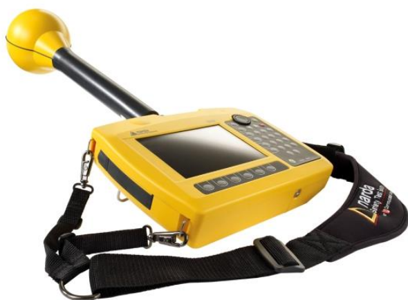
S 5: Uporabljen instrument za merjenje elektromagnetnega sevanja Narda SRM-3006 in primer izvajanja meritev EMS.
