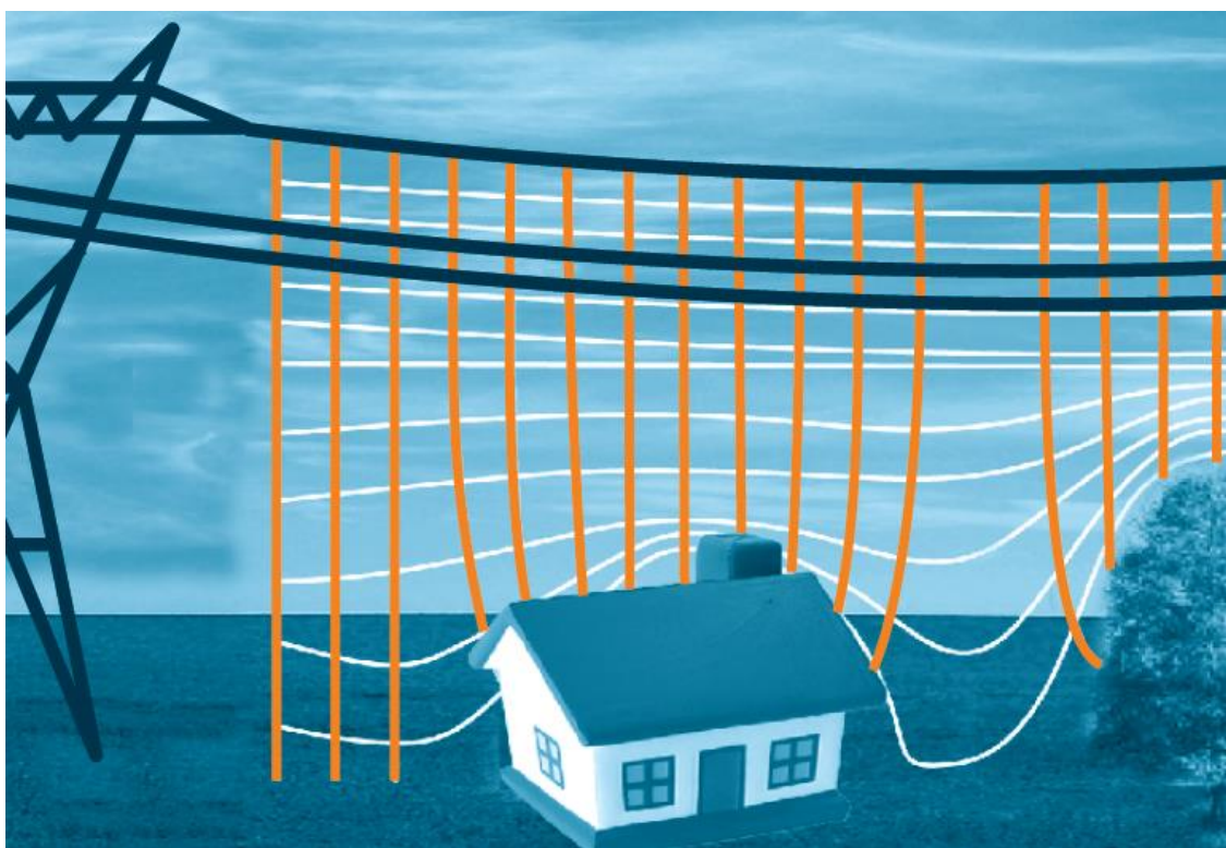
S 1: Vpliv objektov in vegetacije na porazdelitev električnega polja v bližini visokonapetostnega daljnovoda.
