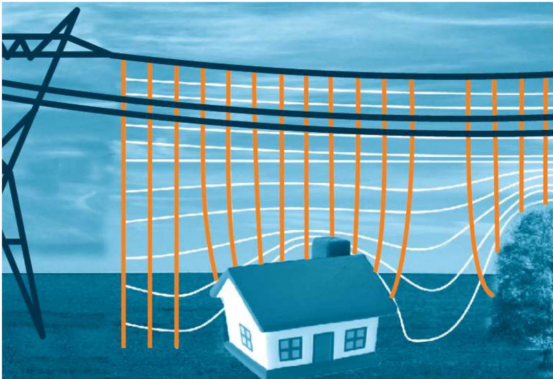
S 1: Vpliv objektov in vegetacije na porazdelitev električnega polja v bližini visokonapetostnega daljnovoda.
