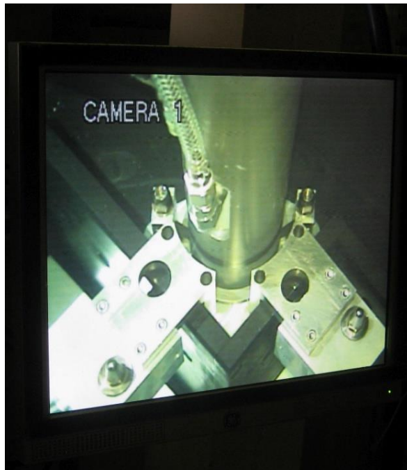
Slika 74: Orodje (levo) in EDM izdelava izvrtin za modifikacijo UFC (Foto: inšpekcija URSJV)
