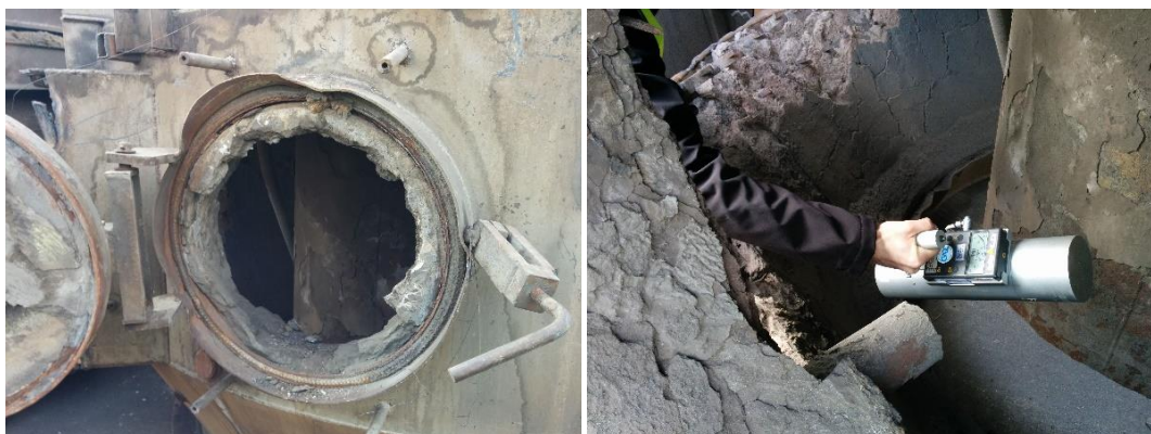
Slika 101: Pogled na del izrabljene industrijske peči, ki je vsebovala obloge s povišano vrednostjo naravnih radioizotopov (levo) in meritve dozne hitrosti, ki jo izvaja strokovnjak ZVD d. o. o. (foto ZVD d. o. o.)
