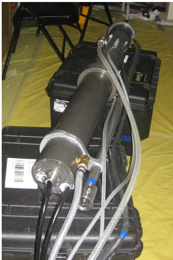
Slika 74: Orodje (levo) in EDM izdelava izvrtin za modifikacijo UFC (Foto: inšpekcija URSJV)
