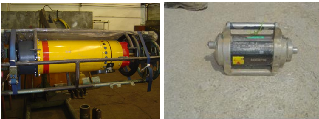
Slika 97: Rentgenska naprava (levo) in defektoskop izvajanje industrijske radiografije. Vidne so tudi izrabljene opozorilne oznake (desno). (Foto: inšpekcija URSJV)
