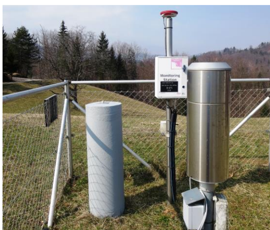
Slika 78: Opazovalna točka GPS nadzora stabilnosti območja odlagališča Boršt GMX1 na lokaciji vremenske postaje Boršt – Gorenja vas – levo in Opazovalna točka GPS nadzora stabilnosti območja odlagališča Boršt GMX2 na zgornji etaži odlagališča - desno
