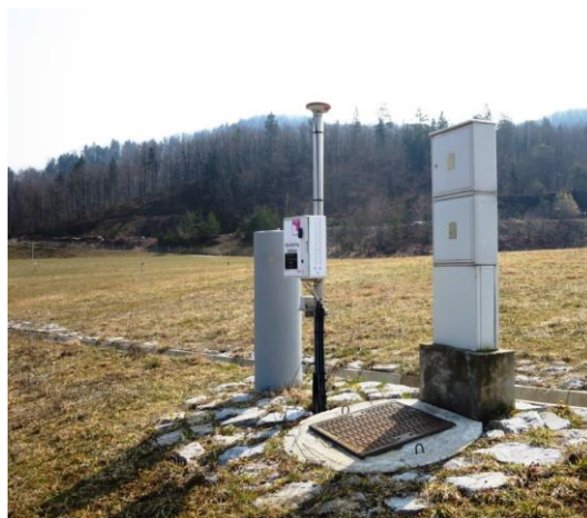
Slika 78: Opazovalna točka GPS nadzora stabilnosti območja odlagališča Boršt GMX1 na lokaciji vremenske postaje Boršt – Gorenja vas – levo in Opazovalna točka GPS nadzora stabilnosti območja odlagališča Boršt GMX2 na zgornji etaži odlagališča - desno
