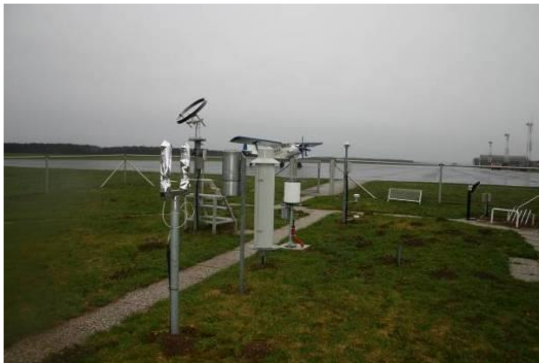
Slika 104: Merilno mesto na letališču Maribor-Slivnica (v ospredju sta sondi za merjenje hitrosti doze ionizirajočega sevanja, v ozadju je vidna meteorološka oprema)
