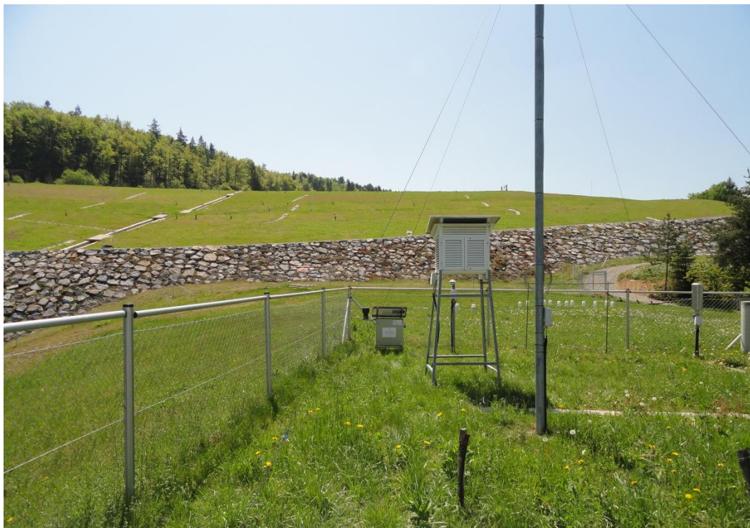
Slika 105: Avtonomna postaja za meritve zunanjega sevanja (v levem kotu), začasno postavljena na območju odlagališča Boršt
