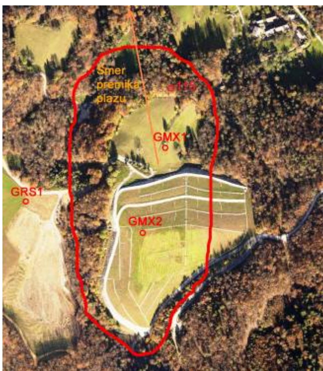
Slika 27: Obseg plazju na območju Boršta, smer gibanja plazju (informativni prikaz), mesta opazovanih točk nadzora z GPS (točke GRS1, GMX1 in GMX2) in geodetske mreže (točka 115)
