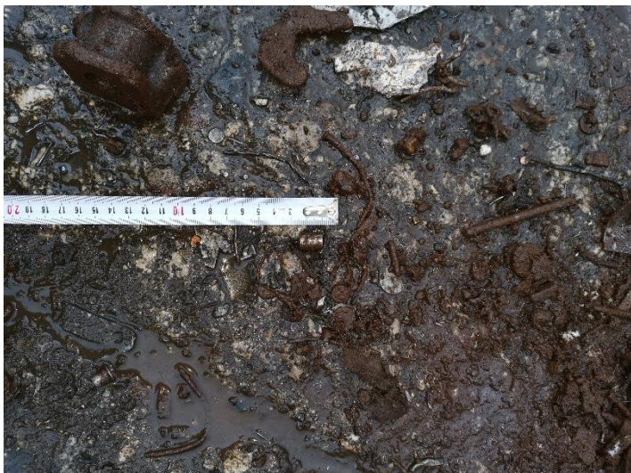
Slika 21: Radioaktivni odpadki z ^{152}\text{Eu} z aktivnostjo približno 1 GBq, najdeni med sekundarnimi surovinami (foto: ZVD d. o. o.)
