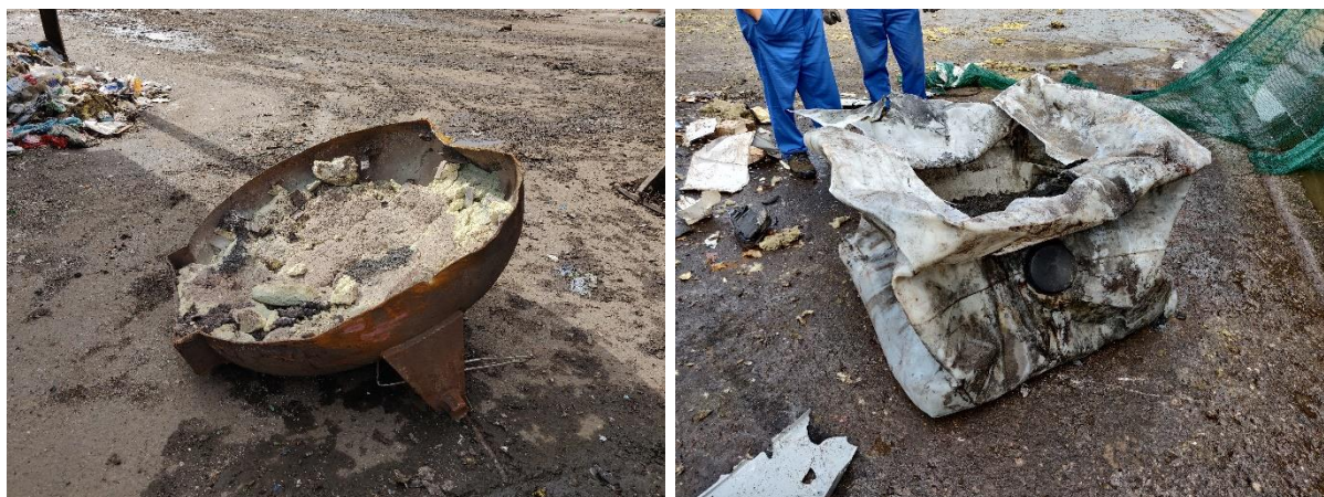
Slika 22: Levo: Šamotna obloga s povišano vrednostjo radionuklidov, najdena v pošiljki odpadnih kovin v podjetju Surovina, d. o. o., na njegovi lokaciji v Mariboru. Desno: Cisterna s snovjo, ki vsebuje povišane vrednosti naravnih radionuklidov, najdena na lokaciji podjetja Dinos, d. o. o., v Naklem (foto: ZVD, d. o. o.).
