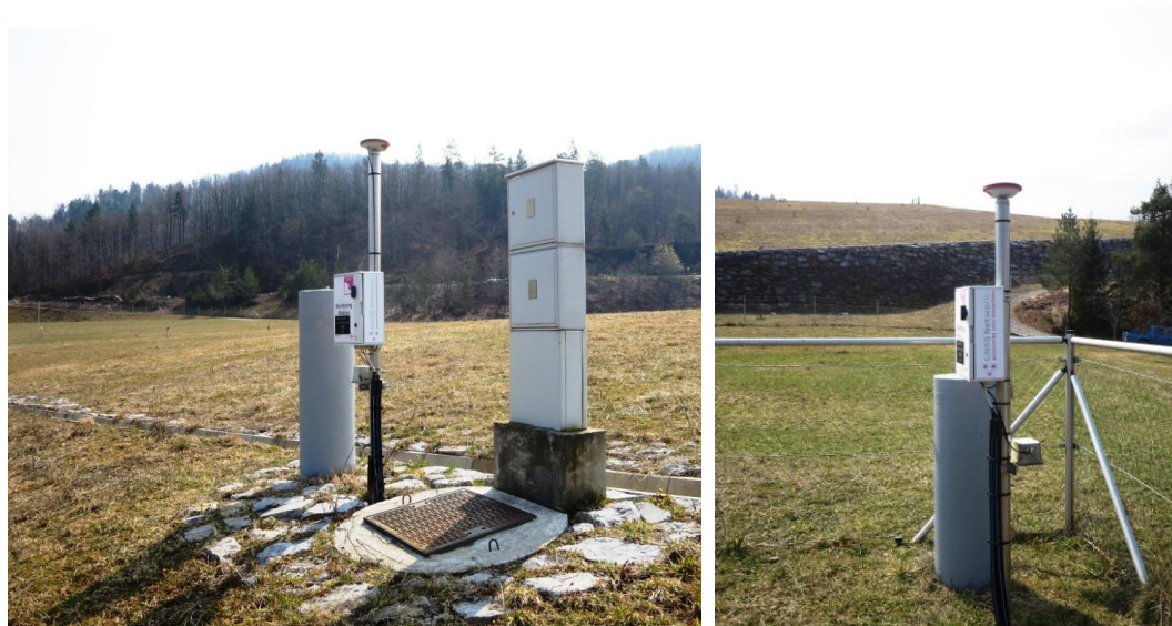
Slika 74: Opazovalni točki GPS nadzora stabilnosti območja odlagališča Boršt, levo GMX2 na zgornji etaži odlagališča, desno GMX1 na vremenski postaji Boršt Gorenja vas
