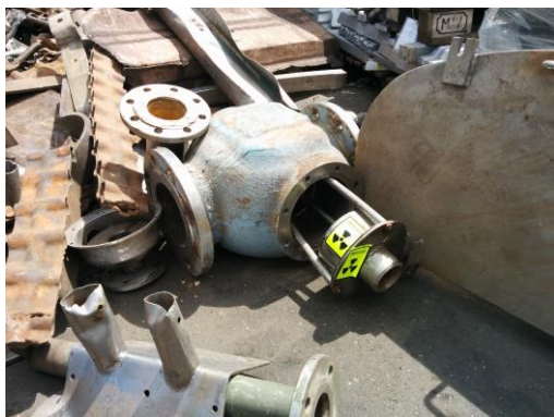
Slika 94: Najdeni strelovod med odpadnim železom (Foto: ZVD d. o. o.)
