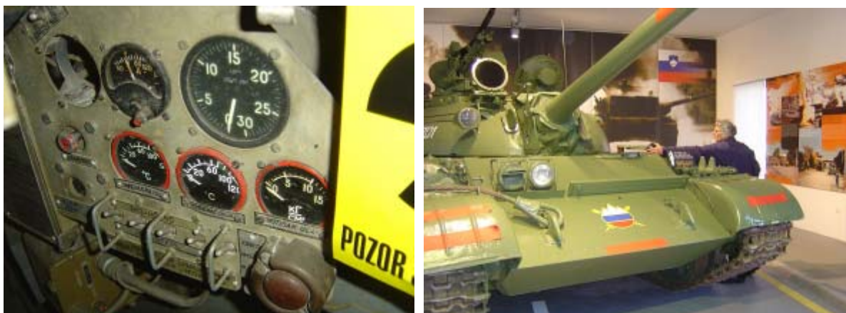
Slika 87: V Parku vojaške zgodovine v Pivki je bila na inšpekciji URSJV identificirano tudi več radioaktivnih številčnic z ^{226}\text{Ra} (levo), nekaj med njimi se je nahajalo v tanku T-55 (desno)
