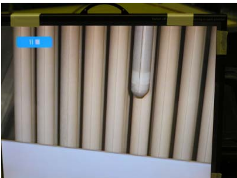
Slika 46: Rekonstitucija nuklearnega goriva: izvlek palice iz gorivnega elementa
