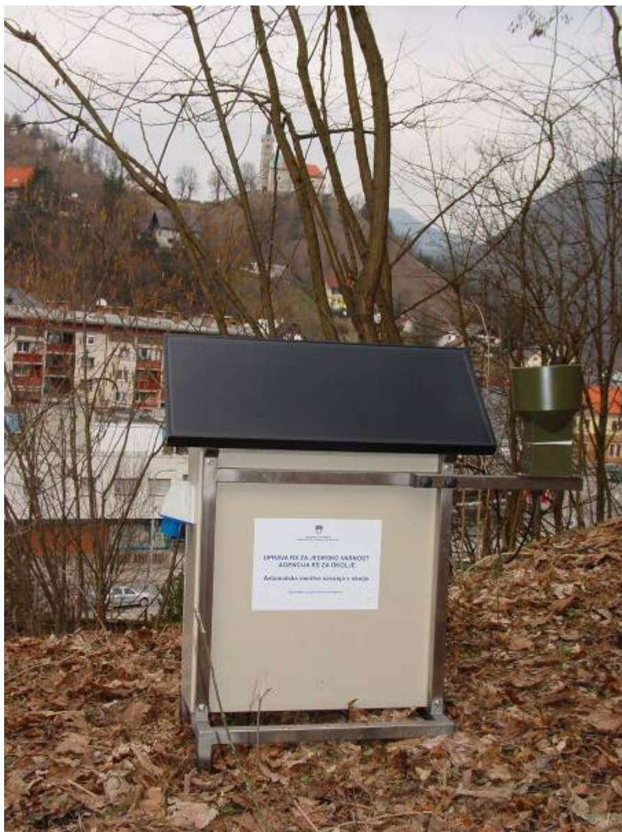
Slika 63: Avtonomna postaja za meritve zunanjega sevanja in količine padavin, začasno postavljena na območju rudnika v Idriji
