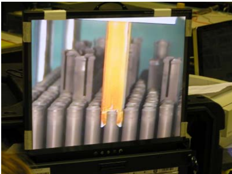
Slika 45: Rekonstitucija nuklearnega goriva: orodje za izvlek palice iz gorivnega elementa
