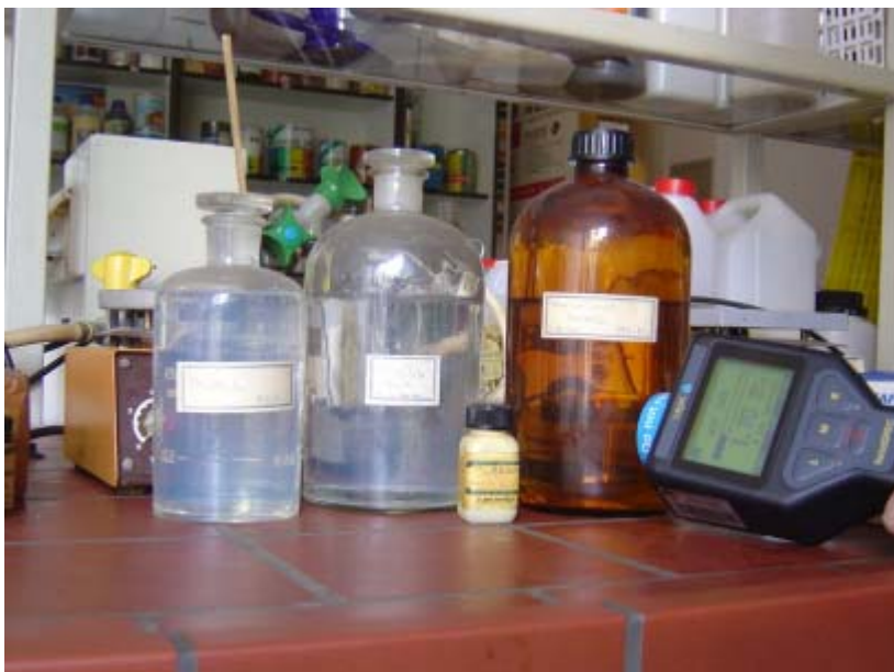
Slika 85: Tekočine s torijem \text{Th}(\text{NO}_3)_4 in radioaktivna kemikalija \text{Th}(\text{NO}_3)_4 \times 5 \text{H}_2\text{O} proizvajalca MERCK brez oznake, ki bi opozarjala na sevanje, so bile identificirane na Oddelku za lesarstvo na Biotehnični fakulteti Univerze v Ljubljani
