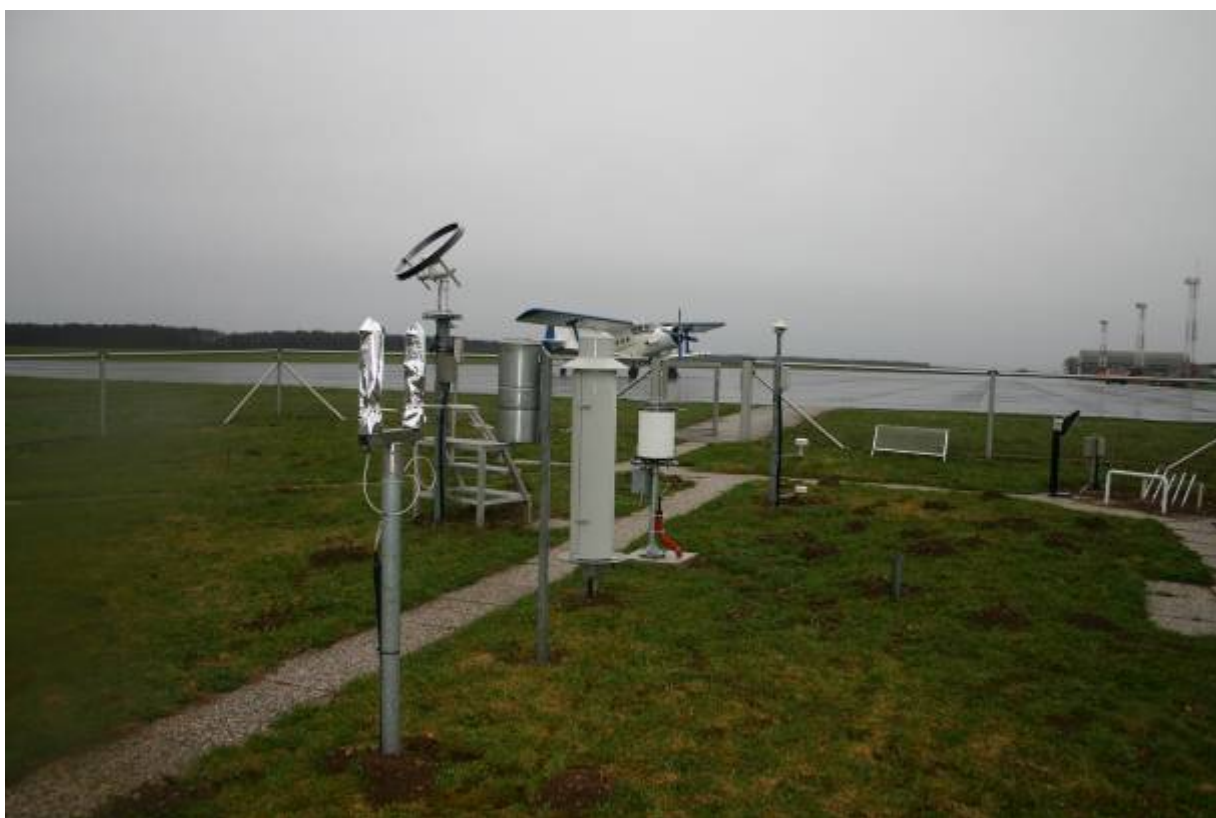
Slika 62: Merilno mesto na letališču Maribor. V ospredju sta sondi za merjenje hitrosti doze ionizirajočega sevanja, v ozadju je vidna meteorološka oprema
