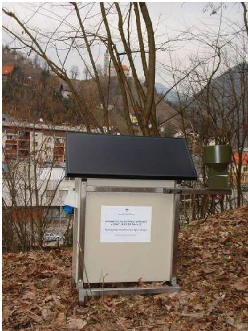
Slika 74: Avtonomna postaja za meritve zunanjega sevanja in količine padavin, začasno postavljena na območju rudnika v Idriji
