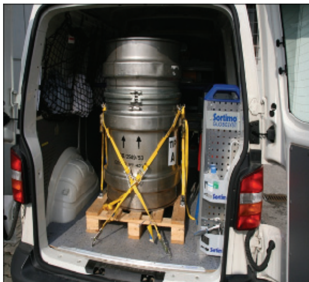
Slika 105: Vpenjalni sistem za pritrjevanje tovorkov v kombiju je izdelan v skladu z EN12195-2
