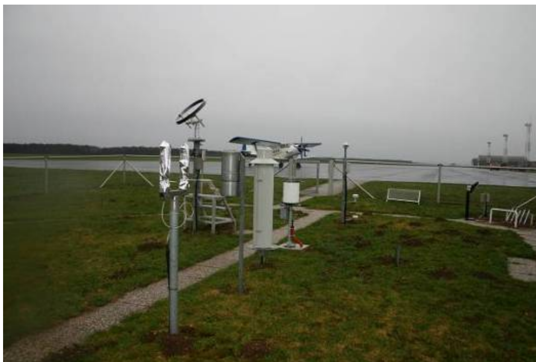
Slika 101: Merilno mesto na letališču Maribor-Slivnica (v ospredju sta sondi za merjenje hitrosti doze ionizirajočega sevanja, v ozadju je vidna meteorološka oprema)
