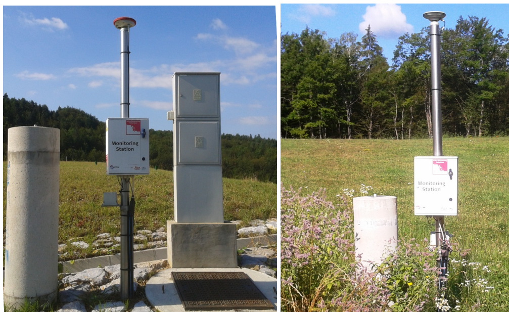
Slika 82: Opazovalni točki GPS nadzora stabilnosti območja odlagališča Boršt, levo GMX2 na zgornji etaži odlagališča, desno GRS1 na saniranem kopu inertnega materiala Jaka za prekrivko odlagališč Jazbec in Boršt
