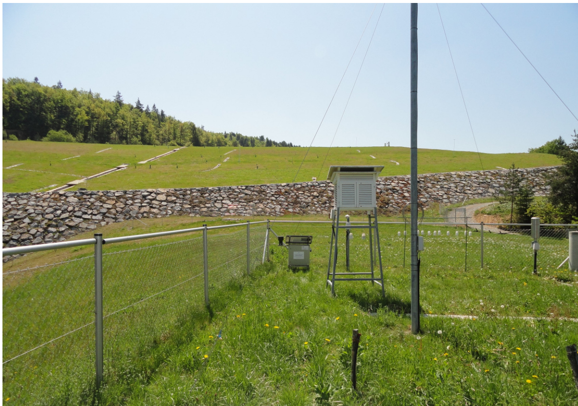
Slika 102: Avtonomna postaja za meritve zunanje sevanja (v levem kotu), začasno postavljena na območju odlagališča Boršt
