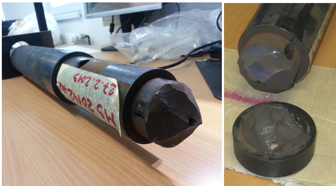
Slika 77: Odlomljeno vreteno izolacijskega ventila glavnega parovoda (Foto: inšpekcija URSJV)
