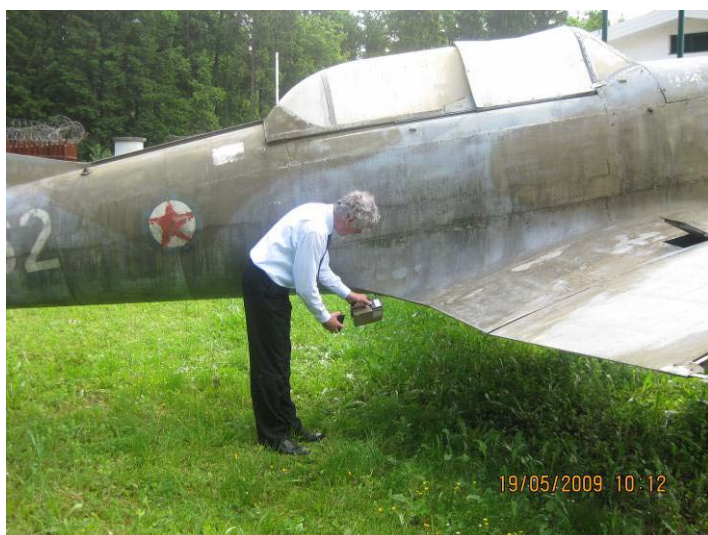
Slika 91: Letalo 522, v katerem se nahaja radioaktivni višinomernik, dozno polje na kontaktu letala je znašalo do 10 \mu\text{Sv/h}
