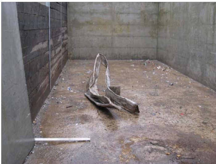
Slika 95: Odpadna cev, ki je povzročala povišano dozno polje na lokaciji zbiratelja odpadnih kovin Remats, d. o. o., Ljubljana (foto: ZVD)
