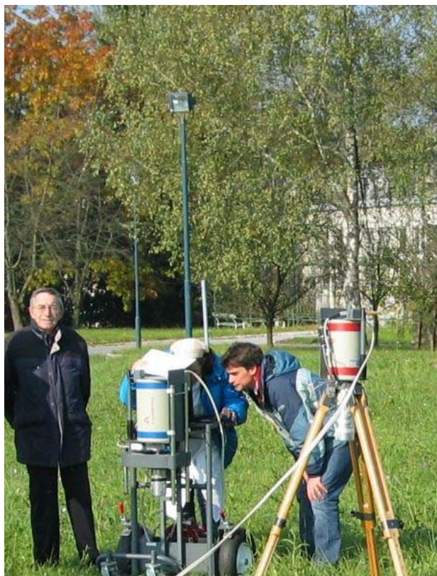
Slika 103: Meritve in-situ spektrometrije gama v okolici reaktorja
