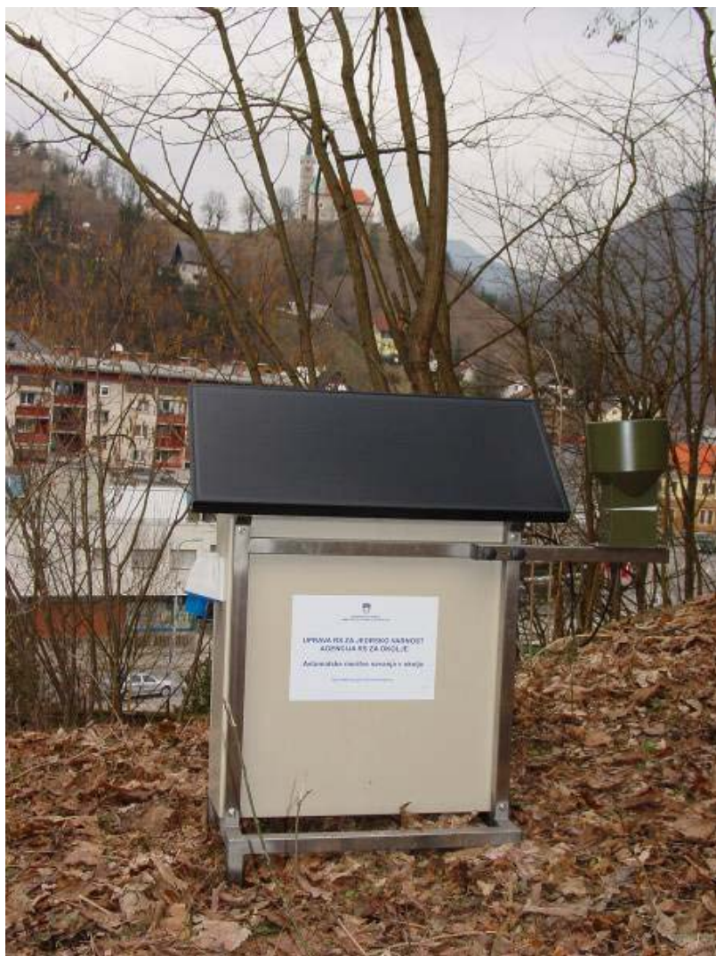
Slika 69: Avtonomna postaja za meritve zunanjega sevanja in količine padavin, začasno postavljena na območju rudnika v Idriji
