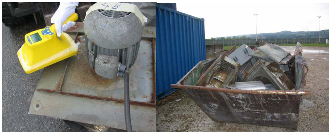
Slika 44: Meritve ventilatorja ter nekontaminirani kovinski predmeti (vir: Poročilo o nadzornih meritvah, ki jih je opravil pooblaščen izvedenec za varstvo pred sevanji Institut »Jožef Stefan«)
