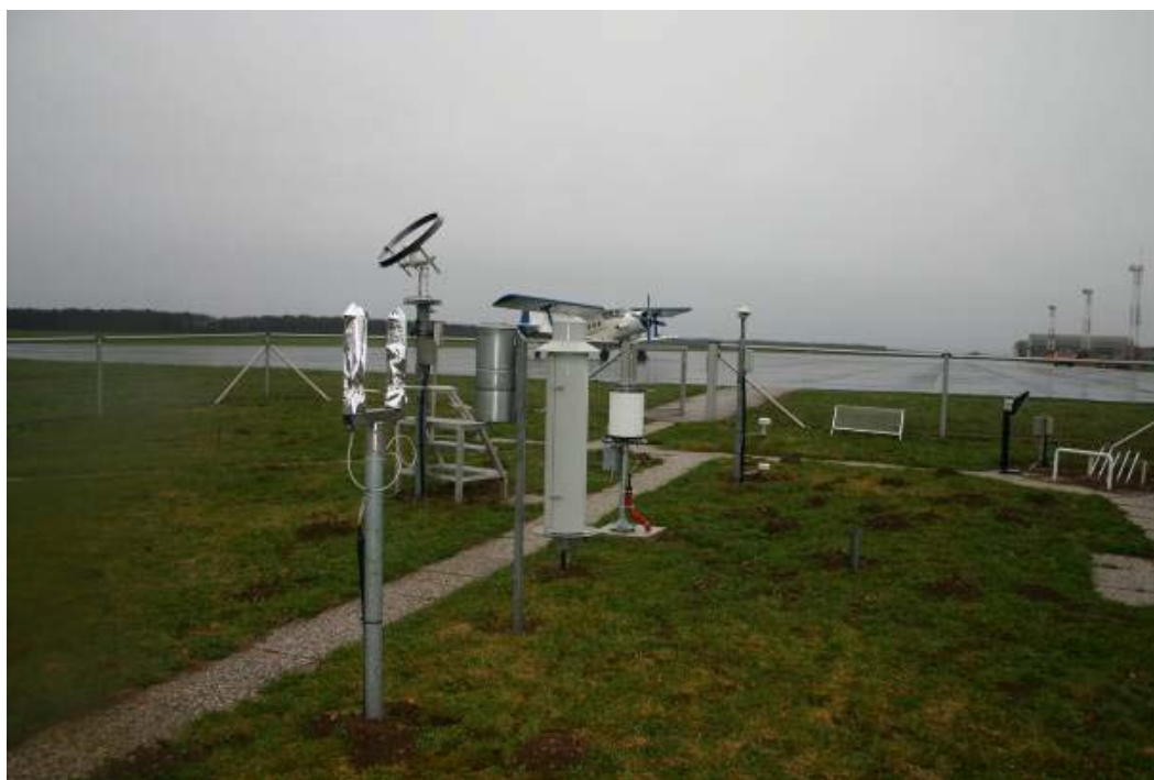
Slika 68: Merilno mesto na letališču Maribor (v ospredju sta sondi za merjenje hitrosti doze ionizirajočega sevanja, v ozadju je vidna meteorološka oprema)
