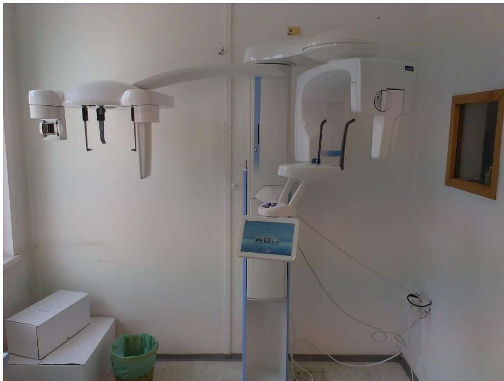
Slika 5. Fotografija panoramskega rentgenskega aparata Planmeca ProMax, ki omogoča tudi cefalometrično slikanje glave.
