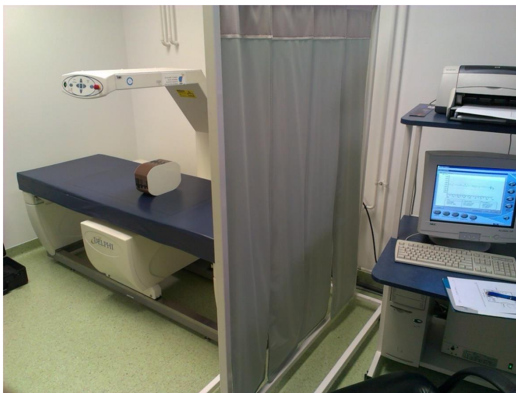
Slika 4. Fotografija rentgenskega merilnika kostne gostote Hologic Delphi s premično zaščito med merilnikom in nadzornim mestom.
