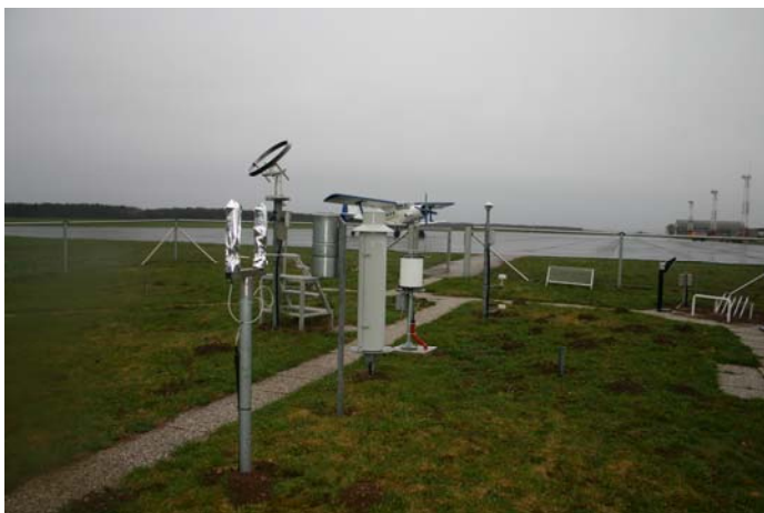
Slika: Merilno mesto na letališču Maribor. V ospredju sta sončni merilniki za merjenje hitrosti doze ionizirajočega sevanja, vidna je tudi meteorološka oprema.
