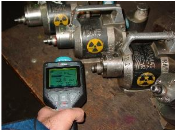
Osiromašen uran kot jedrska snov v napravah, ki se uporabljajo v industrijski radiografiji (Vir: arhiv URSJV)
