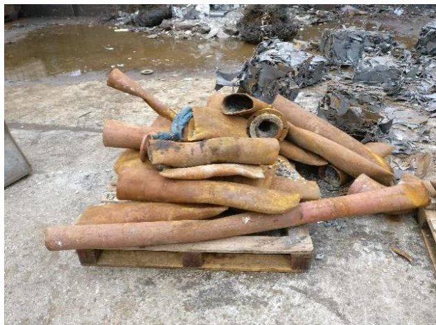
Odpadne industrijske cevi z notranjo oblogo, kjer so bile najdene povišane vrednosti naravnih radionuklidov (Foto: ZVD d.o.o.)
