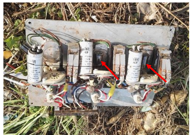
Elektronska cev Cerberus SR 4 z radionuklidom ^{226}\text{Ra} je del elektronskega vezja (zgoraj) in elektronsko vezje (spodaj), ki je vsebovalo več takih cevi (Foto: arhiv ZVD d.o.o.)
