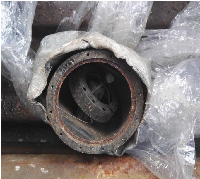
Žiroskop z radionuklidom ^{226}\text{Ra} (Foto: arhiv ZVD d.o.o.)
