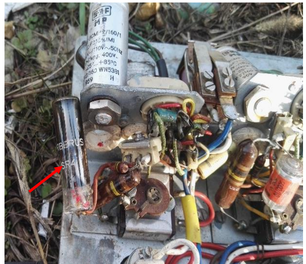
Elektronska cev Cerberus SR 4 z radionuklidom ^{226}\text{Ra} je del elektronskega vezja (zgoraj) in elektronsko vezje (spodaj), ki je vsebovalo več takih cevi (Foto: arhiv ZVD d.o.o.)
