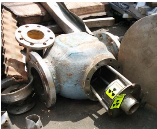
Označen in deloma zaščiten strelovod Foto: arhiv ZVD d.o.o.
