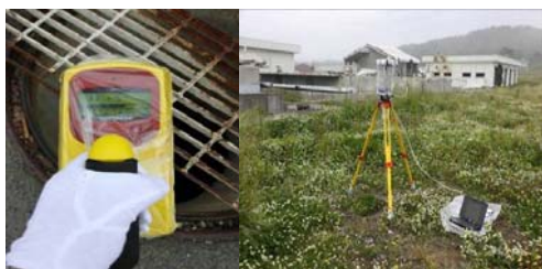
Meritve hitrosti doz in spektrometrija gama in situ na različnih lokacijah okrog elektrarne Fukušima I Foto: arhiv ZVD d.o.o.
