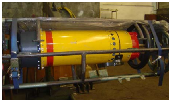
Tipična rentgenska naprava za uporabo v industrijski radiografiji, s katero je mogoče doseči visoke dozne hitrosti (Foto: inšpekcija URSJV)
