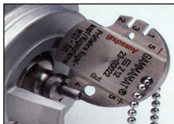
Primer šablone in preverjanja radiografskih sklopov v smislu "gre / ne gre"
