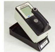
Prenosni merilniki za detekcijo povišanega sevanja, ki jih izvajalci meritev najpogosteje uporabljajo
