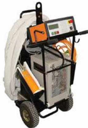
Premična rentgenska naprava za uporabo v industrijski radiografiji (primer uporabe: pregled zvarov na terenu)
